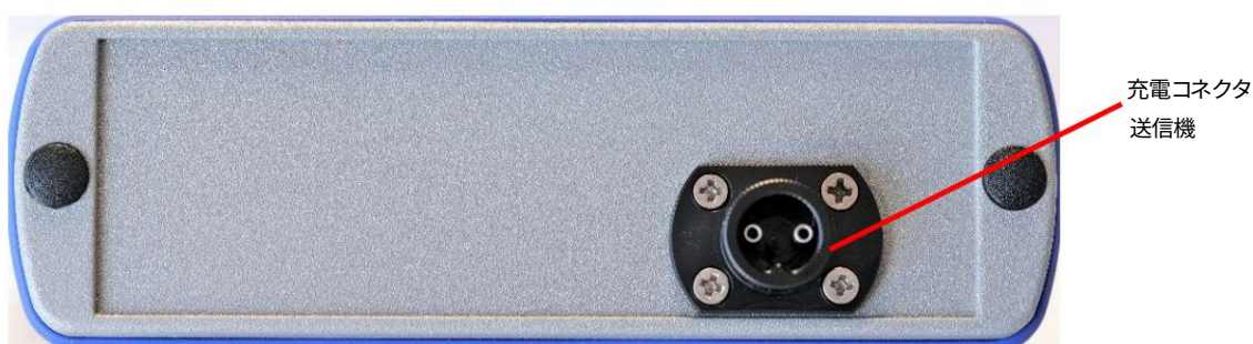
図2.3.1b レシーバー、デバイスの右側にある接続ソケット
