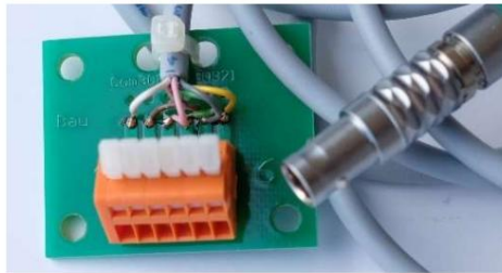
図2.3.1c リレー接続ケーブルと端子の割り当て/ケーブルの色分け
